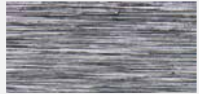
Schleifband mit Korn 40 kurze markante Liniensstruktur, raue Oberfläche, kontrastreiches Finish
