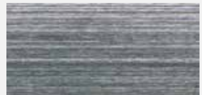
Schleifmoprad mit Korn 40 lange durchgehende Liniensstruktur, minimale Vertiefungen, glattes Finish
