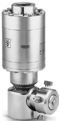
Unser innovativer, selbstantriebener Innenreinigungskopf aus Edelstahl wurde speziell zur Reinigung unterschiedlichster Behälter wie beispielsweise Silos, 20-Fuß-Container oder Bahnkesselwagen entwickelt. Er verfügt über eine ATEX-Zulassung, ist hochbeständig gegen Säuren, Laugen, Lösungsmittel und VE-Wasser und bezüglich Durchsatz, Druck und Drehzahl frei konfigurierbar.
