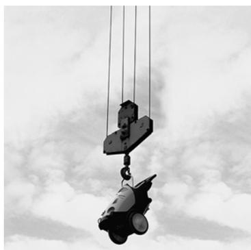
Mit verschiedenen Anbausätzen können die Geräte an die speziellen Anforderungen bestimmter Einsatzbereiche angepasst werden. So ermöglicht zum Beispiel der Anbausatz Kranverladung einen mühelosen Gerätetransport auf Baustellen. Mit dem Anbausatz Münzfernbedienung lassen sich Geräte der HDS-Mittel- und -Superklasse beispielsweise an Tankstellen im SB-Betrieb einsetzen. Und der Anbausatz graue Räder ertüchtigt die Geräte für Einsätze im Lebensmittelbereich oder in Schwimmbädern.
