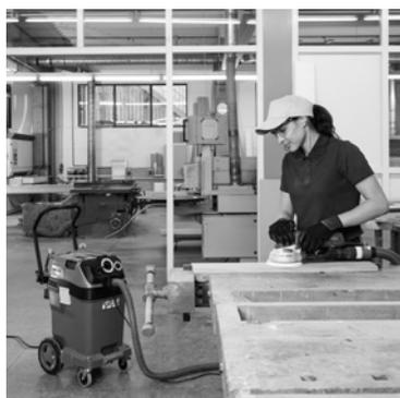
Mithilfe der Kärcher Anschlussmuffen können Saugschläuche perfekt an Elektrowerkzeuge aller gängigen Hersteller angeschlossen werden.
