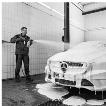
Die handliche Becher-Schaumlanze von Kärcher eignet sich besonders zum Einschäumen bei der Fahrzeugwäsche. Der Reinigungsmitteltank befindet sich direkt an der Lanze. Der Injektor zur Reinigungsmittelansaugung ist in der Lanze integriert und mit vielen Kärcher Geräten kompatibel.
