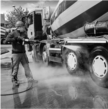
Ob für Auftau- und Enteisungsarbeiten oder zur Entkonservierung von Fahrzeugen – dank der speziellen Messing-Dampfstrahldüsen können Kärcher Heißwasser-Hochdruckreiniger auch im Dampfbetrieb eingesetzt werden.
