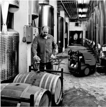
Auch für die Fass- und Behälterreinigung bietet Kärcher zahlreiche Zubehöre, die in Verbindung mit Kärcher Hochdruckreinigern perfekte Ergebnisse versprechen. Zum Beispiel die Spritzköpfe aus der HKF-Reihe. Sie eignen sich optimal zur Innenreinigung von Behältern mit bis zu 3000 Liter Fassungsvermögen und Öffnungen ab 50 Millimeter. Oder der speziell für die Reinigung von Eichenholzfässern entwickelte BC 14/12, der sogar mit einer integrierten Absaugfunktion aufwartet.
