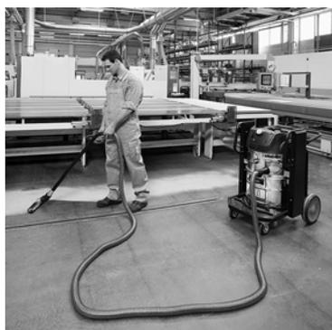
Der passende Schlauch zur jeweiligen Anwendung ist unabdingbare Voraussetzung für sicheres Saugen. Die Bandbreite reicht von Anwendungen wie dem Saugen von Mineralstaub über das Saugen abrasiven und flüssigen Saugguts wie mit Spänen versetzten Flüssigkeiten und Öl hin zu Metallspänen und heißer Schlacke. Bei der Auswahl sind Zubehörmennweite und Schlauchlänge zu berücksichtigen.
