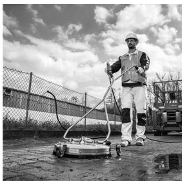
Schluss mit dem lästigen Nachspülen! Die Flächenreiniger FRV 30, FRV 30 Me und seit neuem auch der FRV 50 Me reinigen mit höchster Flächenleistung spritzwasserfrei und saugen das Schmutzwasser gleichzeitig automatisch ab.
