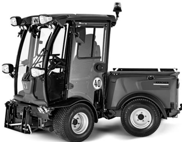
Der MIC 50 ist der speziell für Kommunen entwickelte kompakte Geräteträger in der 3,5-Tonnen-Klasse und überzeugt auf der Straße wie auch offroad. Beim Mähen sind bis zu 3 Meter Arbeitsbreite möglich. Konfigurieren Sie Ihren MIC 50 nach Wunsch. Nur Fahrzeugrahmen und Kabine sind immer gleich. Fahrtrieb, Räder, Arbeits- und Bewegungshydraulik können individuell kombiniert werden.
