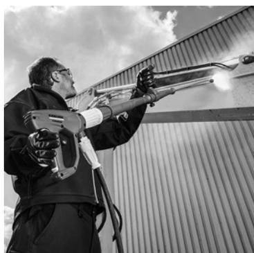
Rüsten Sie Ihren Hochdruckreiniger mit dem neuen Hochdruck-Zubehör auf: Die EASY!Force-HD-Pistole nutzt die Rückstoßkraft des Hochdruckstrahls und reduziert damit die Haltekraft für den Anwender auf null. Bei der EASY!Force-Hochdruckpistole bestehen sowohl die Kugel als auch der Dichtsitz des Ventils aus Keramik, die viel härter ist als jeder denkbare Fremdpartikel. Das Vollkeramikventil sorgt so für eine rund 5-mal längere Lebensdauer im Vergleich zu anderen Hochdruckpistolen.
