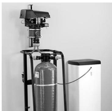
Kalkreiches Wasser kann zu Kalkrückständen führen, wodurch die Leistungsfähigkeit der Module drastisch sinken kann. Zuverlässigen Schutz vor Kalkflecken bieten die mobilen Kärcher Wasserenthärter und der Solarreiniger RM 99. Im Wasserenthärter entzieht ein Ionentauscherharz dem Wasser den gelösten Kalk und reduziert den Härtegrad auf 0-1 °dH.
