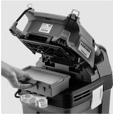
Für jede Anwendung den perfekten Filter: Kärcher Flachfaltfilter sind in verschiedenen Materialien erhältlich. Vom Standardfilter aus Zellulose bis hin zum PTFE-Filter für Problemstäube wie feuchter Beton.
