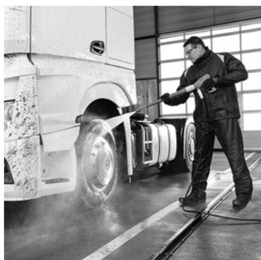
Kärcher Strahlrohre aus hochwertigem Edelstahl in verschiedenen Längen sind unter Druck um 360° drehbar. Sie verfügen über ergonomisch geformte Griffschalen und große Handverschraubungen für eine optimale Handhabung und Isolation. Spezialstrahlrohre erweitern die Einsatzbereiche von Hochdruckreinigern bedeutend. Zum Beispiel das flexible Strahlrohr – es eignet sich bestens zur Reinigung schwer erreichbarer Stellen. Oder das Teleskopstrahlrohr für die Decken- und Fassadenreinigung.
