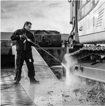
Der Kärcher Dreckfräser vereinigt die Vorteile von Punkt- und Flachstrahl. Für eine hohe Reinigungskraft und eine hohe Flächenleistung sorgt der rotierende Strahl mit circa 4000 U/min um die eigene Achse.
