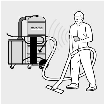
Zubehöre, wie beispielsweise Fernbedienungen für Industriestaubsauger oder Kabeltrommeln zur Erweiterung von Arbeitsbereichen, ermöglichen dem Anwender im Alltag eine Erleichterung vieler Arbeitsschritte.
