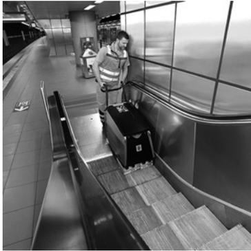
Für die verschiedenen Rolltreppenhersteller stehen jeweils passende Ein- und Auslaufkämme zur Verfügung. Diese verhindern, dass Nässe in die Rolltreppe gelangt.
