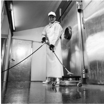
Flächenreiniger bieten eine massive Flächenleistung und reinigen spritzwasserfrei. Es gibt sie mit Kunststoff- und Edelstahlhaube (Heißwasserbetrieb). Tipp für extragroße Flächen: der FR 50 Me.
