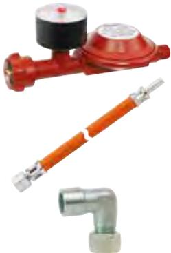
zum Anschluss an Gasflaschen, zur Druckregelung auf den Nenndruck des Gasgerätes bestehend aus: Niederdruckregler Typ EN61 mit thermischer Absperrvorrichtung „T“ (TAE), Manometer, Mitteldruck-Schlauch (Gummi mit Textileinlage; kältebeständig bis -30 °C; Schlauchabmessung 6,3 x 3,5 mm) G 1/4 LH-ÜM x RST 8 x 1000 mm und Winkel-Aufschraubverschraubung Typ WAI IG G 1/2 x RVS 8
