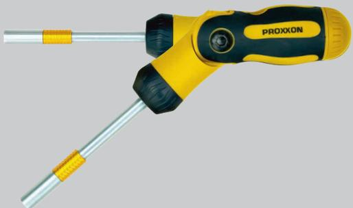
Verrastung des Griffes durch Knopfdruck in normaler und abgewinkelter Version. Umschaltung von Rechts- auf Linkslauf durch Drehen des Schaltringes. In Mittelstellung wird die Ratschenfunktion eliminiert. Autolock-System: Bits werden nach Einschieben automatisch mittels Feder und Magnet fixiert. Zum Entnehmen Auswerfer nach hinten schieben.
