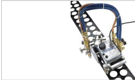
mit einem Schneidbrenner
