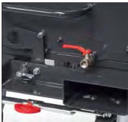
Ablasshahn und TOTALSTOP-Zentralbrems-system
