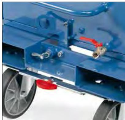
Ablasshahn und TOTALSTOP-Zentralbrems-system
