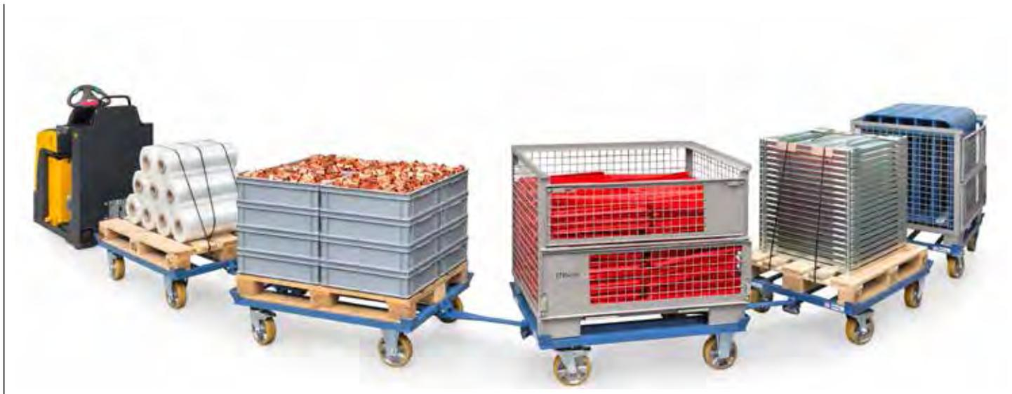
Routenzug mit Elektroschlepper und 5 Paletten-Fahrgestellen
