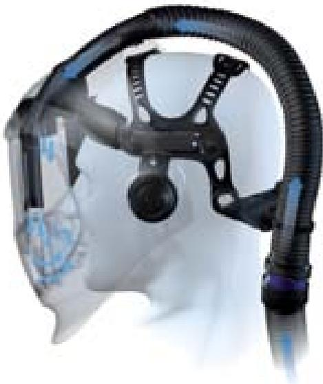
**Airflow:** Der mittlere Kanal hält den Schweißfilter beschlagfrei, die beiden Seitenkanäle sorgen für sanfte Luftzufuhr in die Mund- und Nasenregion.
